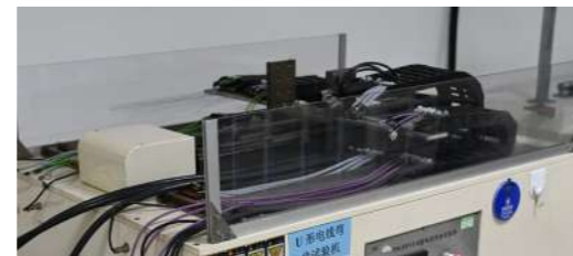
ドラッグチェーン試験の説明 ドラッグチェーンの長さ: 0.6m; 曲げ半径: 50mm; スピード: 60 s/min
