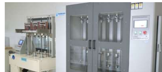
ねじり試験の説明 固定距離: 0.5m; ねじれ角: ±180° リフトアップ重量: 500g; スピード: 60s/min
