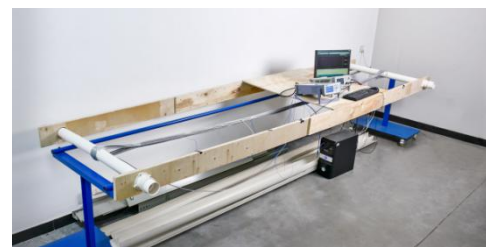
图 8 - 兆龙互连实验室测试线缆升温设备
