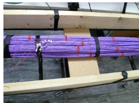
图 9 - 兆龙互连实验室测试线缆升温
