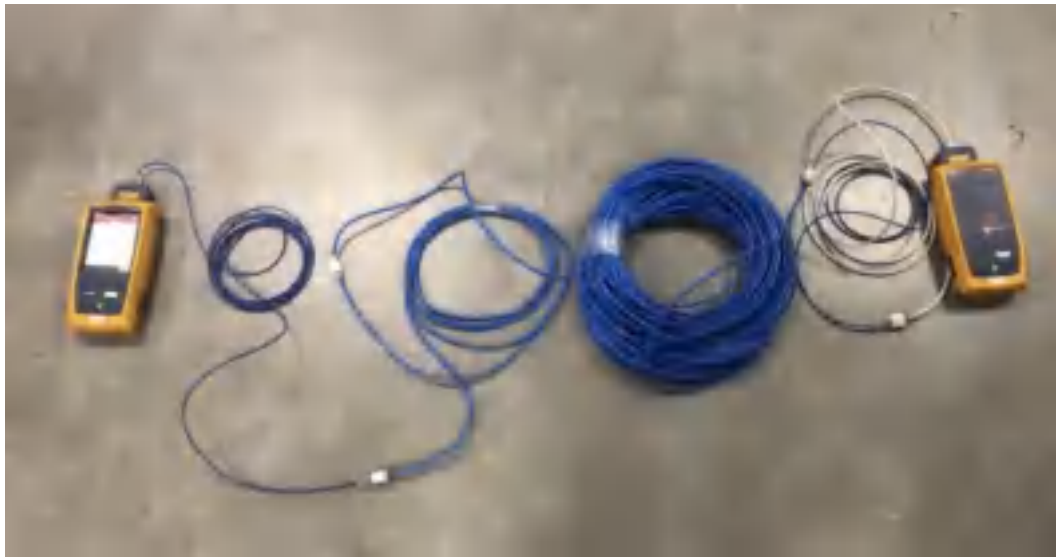
图 2: 使用 28AWG 极细跳线的信道测试现场
